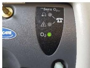
Die grüne LED zeigt an, dass das Gerät richtig funktioniert
